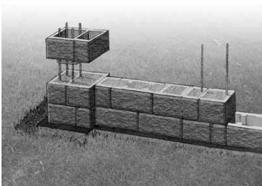
W ogrodzeniu Bastion kolejne elementy powinny być montowane z przewiązaniem, tak aby pionowe spoiny nie pokrywały się. W ogrodzeniu Moderno układ spoin może być wykonany z przesunięciem bądź bez. Po ułożeniu każdej kolejnej warstwy należy sprawdzić poziom i pion, a ewentualne odchyłki należy skorygować przez zeszlifowanie lub zastosowanie klinów do glazury.
